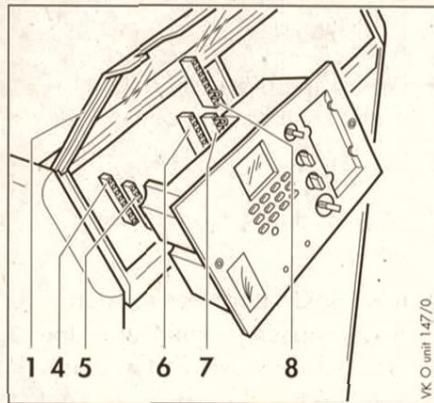
Abb. 6.6 Montage eines VRC-Sets
