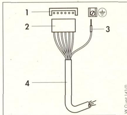
Abb. 6.4 Steckeranschluß eines VIH-Speichers mit Funktionsschaltleiste
