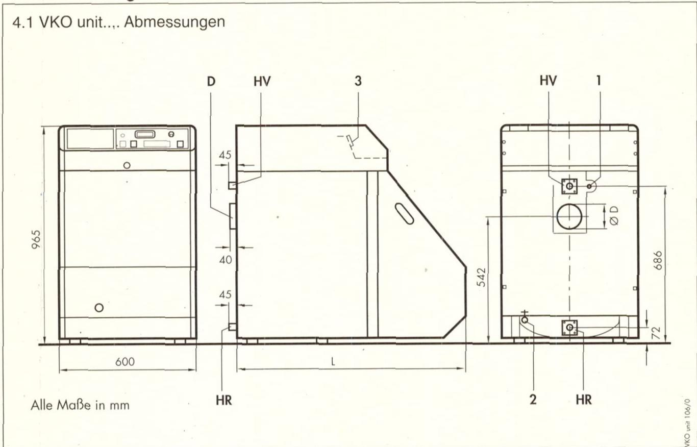
Abbildung 4.1 VKO unit... Abmessungen
