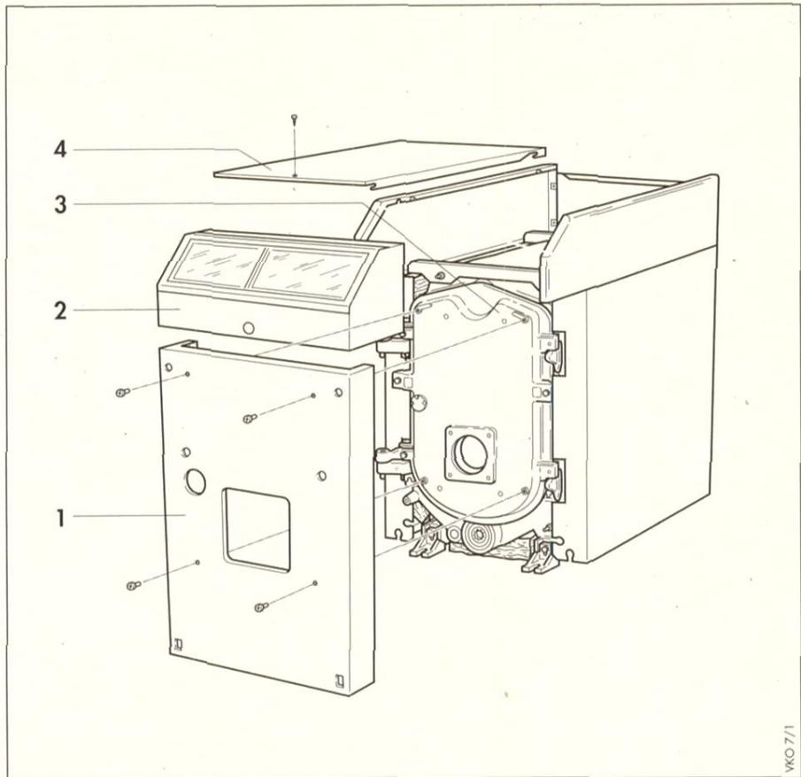
**Abb. 5.7 Kesselverkleidung komplettieren**
