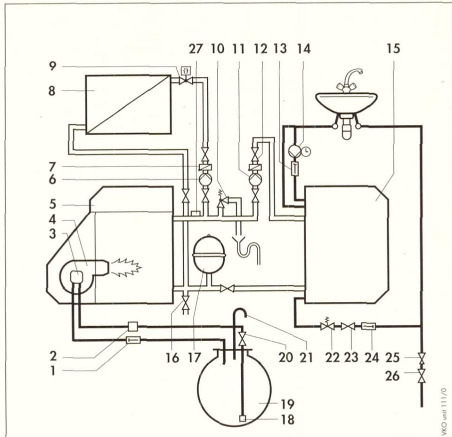
Abb. 5.10 Heizkreisschema VKO unit...
