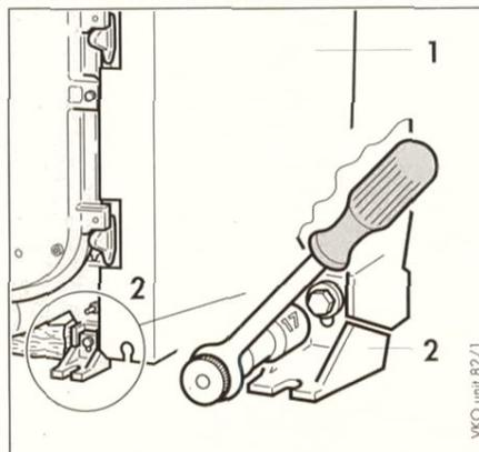
Abb. 5.2 Verstellbare Kesselfüße
