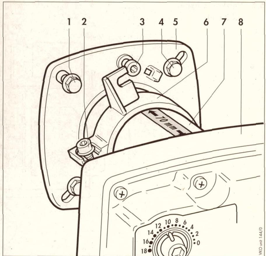
Abb. 5.8 Gebläsebrenner montieren
