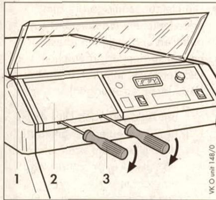
Abb. 6.5 Abnehmen Abdeckung für VRC...
