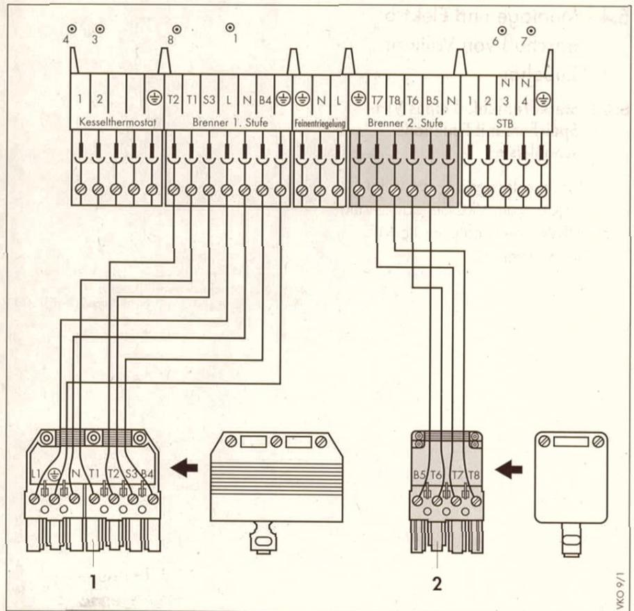
**Abb. 6.3 Gebläsebrenner-Anschlußkabel**
