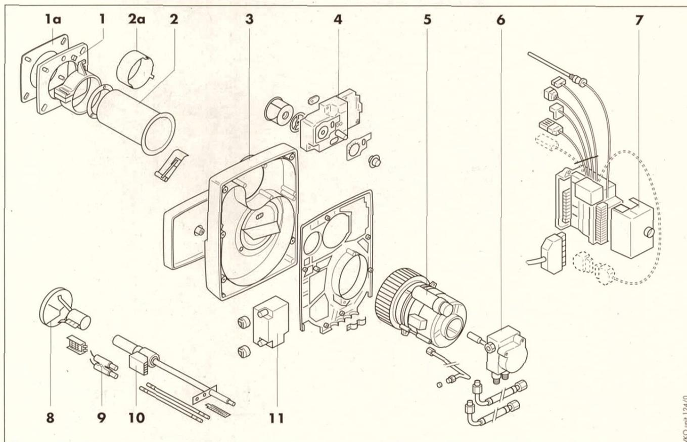
Abb. 10.2 Brenner Einzelteile
