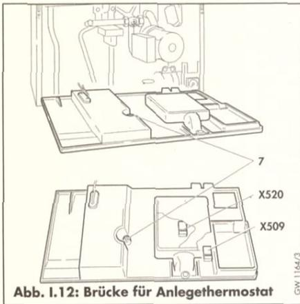
Abb. I.12: Brücke für Anlegethermostat
