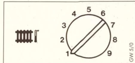
Normalerweise läßt sich der Vorlauftemperatur-Regler stufenlos im Bereich von 1-7 bis zu einer Vorlauftemperatur von maximal 75 °C einstellen. Sollte jedoch der Einstellbereich an Ihrem Vaillant Thermoblock von 1-9 einstellbar sein, so hat Ihr Fachmann den Einstellknopf entsprechend justiert, um den Betrieb der Heizungsanlage im Temperaturbereich mit Vorlauftemperaturen bis maximal 90 °C zu ermöglichen.
