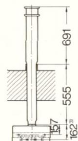
Direkter Geräteanschluß an der Luft-/Abgasführung
