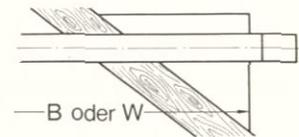
Führung durch Dach
