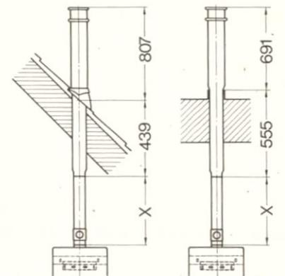
Geräteanschluß über Verlängerung mit Prüfföffnung
