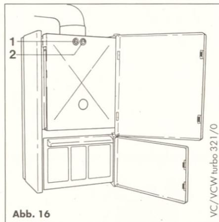
Für die Messung Funktionsschalter (3) bei Inbetriebnahme des Gerätes gemäß Abbildungen **einschalten**.
