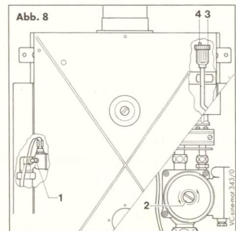
Zum Entlüften Schraube am Primärwärmetauscher (1) und an der Heizungspumpe (2) ca. 1-2 Umdrehungen lösen.
