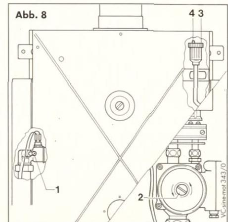
Zum Entlüften Schraube am Primärwärmetauscher (1) und an der Heizungspumpe (2) ca. 1-2 Umdrehungen lösen.
