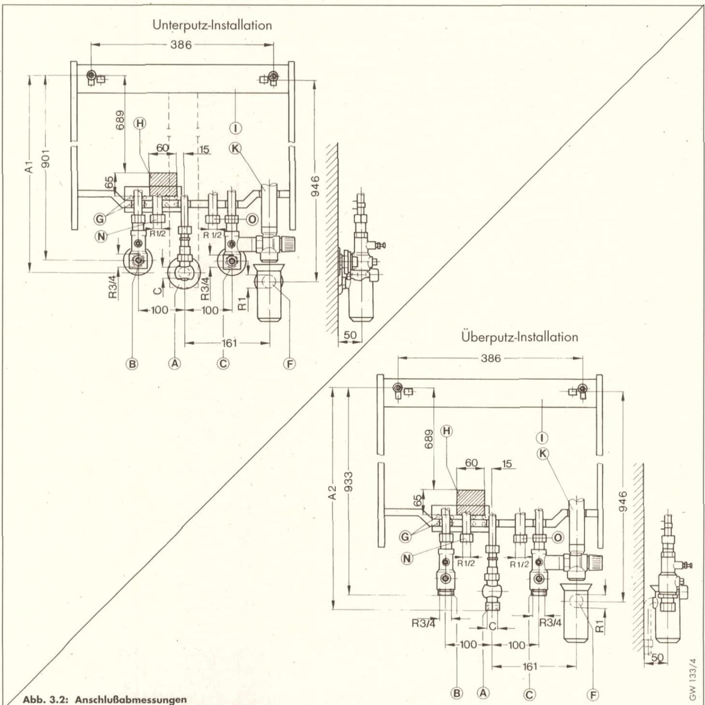
Abb. 3.2: Anschlußabmessungen
