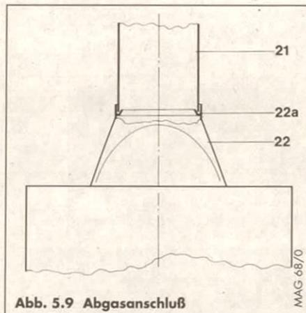
Abgasrohr (21) in die Strömungssicherung (22) des Gerätes einsetzen. Hierbei auf richtigen Sitz des Rohres im Kragen (22a) der Strömungssicherung achten.
