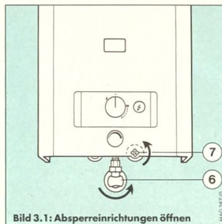
Bild 3.1: Absperrrichtungen öffnen
