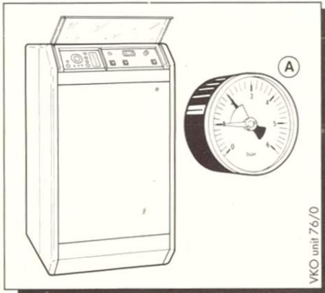
Abb. 10 Wasserstand kontrollieren
