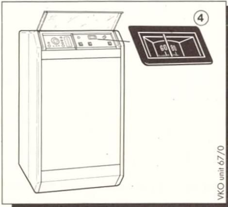
Abb. 2 Kesseltemperatur anzeigen
