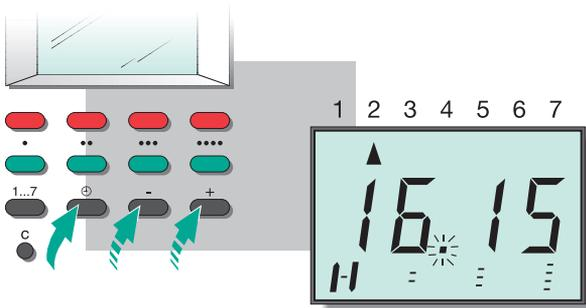
5 Plus- oder Minus-Taste so oft drücken, bis die aktuelle Uhrzeit angezeigt wird. Alle Tasten loslassen.
