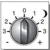
Der Drehknopf für die Nacht-Temperatur (3) befindet sich in Stellung „0“. Mit dieser Grundeinstellung wird während der Nacht (d.h. während der Absenkephase) eine Raumtemperatur von 10 °C erreicht. Jeder Skalenstrich bedeutet eine Temperaturänderung von 2,5 °C.
