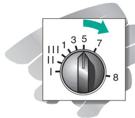
Um die Raumtemperatur zu erhöhen: Drehknopf nach rechts drehen. Die Heizkennlinie wird nach oben verschoben.
