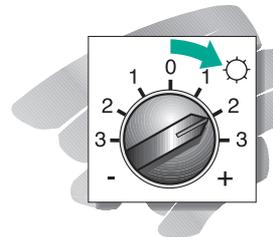
Um die Raumtemperatur zu erhöhen: Drehknopf nach rechts drehen.
