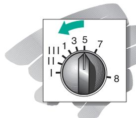
Um die Raumtemperatur zu verringern: Drehknopf nach links drehen. Die Heizkurve wird nach unten verschoben.
