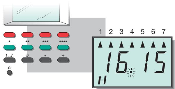
6 Nach wenigen Sekunden werden außer der Uhrzeit alle Wochentag-Dreiecke angezeigt. (Dies ist die Ausgangssituation für die Blockprogrammierung, die im Kapitel 5.2 beschrieben ist.)
