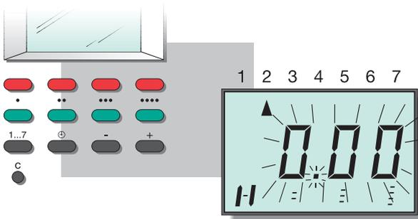
3 Nach wenigen Sekunden blinkt die Uhrzeit-Anzeige im Display.
