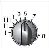
Am Drehknopf 2 (s. Abb. Geräteübersicht, Seite 3) können Sie die Heizkurve verändern. Das ist erforderlich, wenn sich bei niedrigen Außentemperaturen die gewünschte Raumtemperatur nicht einstellt. Drehen Sie zuvor die Thermostatventile in allen Räumen voll auf und schließen Sie alle Türen und Fenster. Die Standardeinstellungen des Drehknopfes Heizkurve sind:
