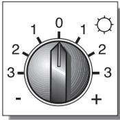
Der Drehknopf für die Tag-Temperatur (Knopf 4 in der Geräteübersicht) befindet sich in Stellung „0“. Mit dieser Grundeinstellung wird eine Raumtemperatur von 20 °C erreicht, wenn die im Raum vorhandenen Thermostatventile voll geöffnet sind. Voraussetzung ist, daß die Heizkurve korrekt eingestellt ist (vgl. Kapitel 6.1) Jeder Skalenstrich bedeutet eine Temperaturänderung von 2,5 °C.
