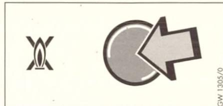
Das Gerät schaltet ebenfalls bei Wassermangel bzw. Trockenbrand auf „Störung“. Diese „Störung“ wird durch den Fehlercode „F 22“ angezeigt. Das Gerät darf erst wieder in Betrieb genommen werden, wenn die Heizungsanlage ordnungsgemäß mit Wasser gefüllt ist (siehe Kap. „Wasserstand kontrollieren“, Seite 9). Die „Entstörung“ erfolgt ebenfalls durch Drücken des Entstörknopfes oder durch Aus/Einschalten des Hauptschalters.
