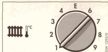
Normalerweise läßt sich der Vorlauftemperatur-Regler stufenlos im Bereich von 1-7 bis zu einer Vorlauftemperatur von maximal 75 °C einstellen. Sollte jedoch der Einstellbereich an Ihrem Vaillant Thermoblock turboTEC von 1-9 einstellbar sein, so hat Ihr Fachmann den Einstellknopf entsprechend justiert, um den Betrieb der Heizungsanlage im Temperaturbereich mit Vorlauftemperaturen bis maximal 90 °C zu ermöglichen.
