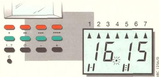
**6** Nach wenigen Sekunden werden außer der Uhrzeit alle Wochentag-Dreiecke angezeigt. (Dies ist die Ausgangssituation für die Blockprogrammierung, die im Kapitel 7.5 beschrieben ist).
