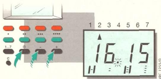
**5** Plus- oder Minus-Taste so oft drücken, bis die aktuelle Uhrzeit angezeigt wird. Alle Tasten loslassen.
