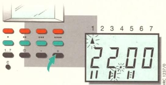
**7** Plus-Taste drücken, bis die gewünschte Uhrzeit (22.00) angezeigt wird. Sie haben jetzt für Anwendung 1 am Montag einen zweiten Zeitabschnitt eingestellt, die Einstellungen sind aber noch nicht gespeichert!
