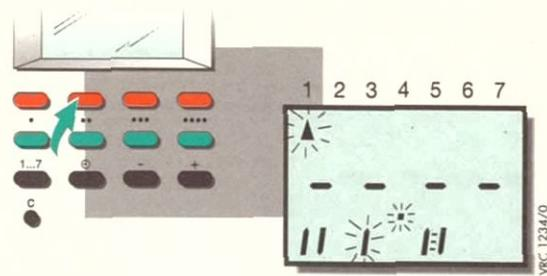
**4** Zweite rote Taste drücken. Der linke Balken für die 2. Einschaltzeit der Anwendung 1 blinkt. Der bisher kein zweiter Zeitabschnitt programmiert ist, wird keine Uhrzeit angezeigt (---).
