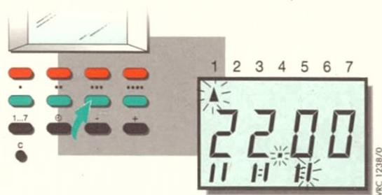
**8** Dritte grüne Taste drücken. Die derzeit programmierte Ausschaltzeit (22.00) wird angezeigt, der rechte Balken für die 1. Ausschaltzeit des Heizkessels blinkt.
