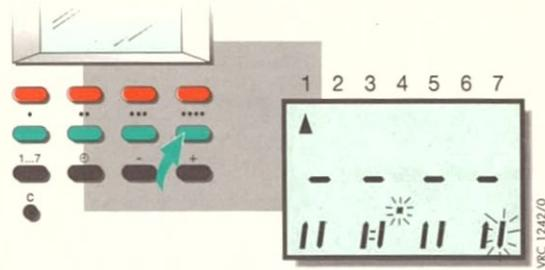
**12** Vierte grüne Taste drücken. Der rechte Balken für die 2. Ausschaltzeit der Anwendung 2 blinkt. Da bisher kein zweiter Zeitabschnitt programmiert ist, wird keine Uhrzeit angezeigt (---).
