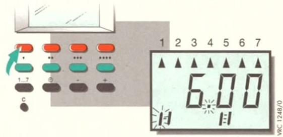
**2** Mit Hilfe der vier rot/grünen Tastenpaare den jeweiligen Ein- bzw. 2. Ausschaltzeitpunkt anwählen, der geändert oder neu eingerichtet werden soll (hier: Einschaltzeitpunkt Anwendung 1 im Standardprogramm 6.00).
