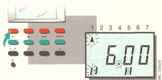
**2** Erste rote Taste drücken. Der linke Balken für den 1. Einschaltzeitpunkt der Anwendung 1 blinkt. Der zugewiesene Einschaltzeitpunkt wird angezeigt (hier 6.00).
