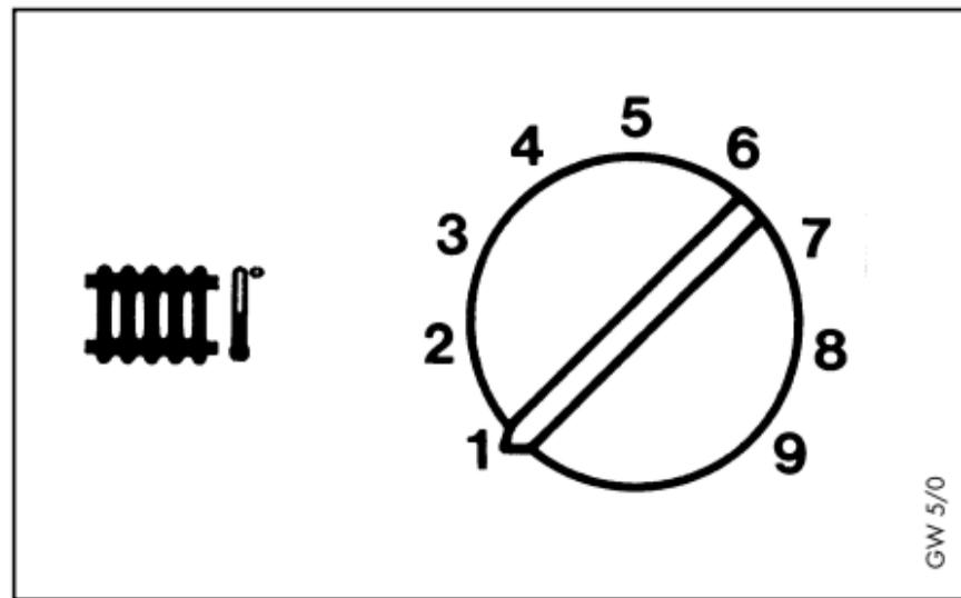
Normalerweise läßt sich der Vorlauftemperatur-Regler stufenlos im Bereich von 1-7 bis zu einer Vorlauftemperatur von max. 75 °C einstellen.
