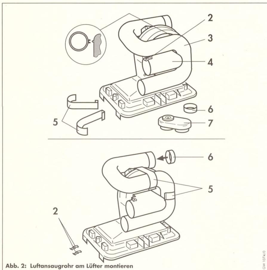
Abb. 2: Luftansaugrohr am Lüfter montieren
