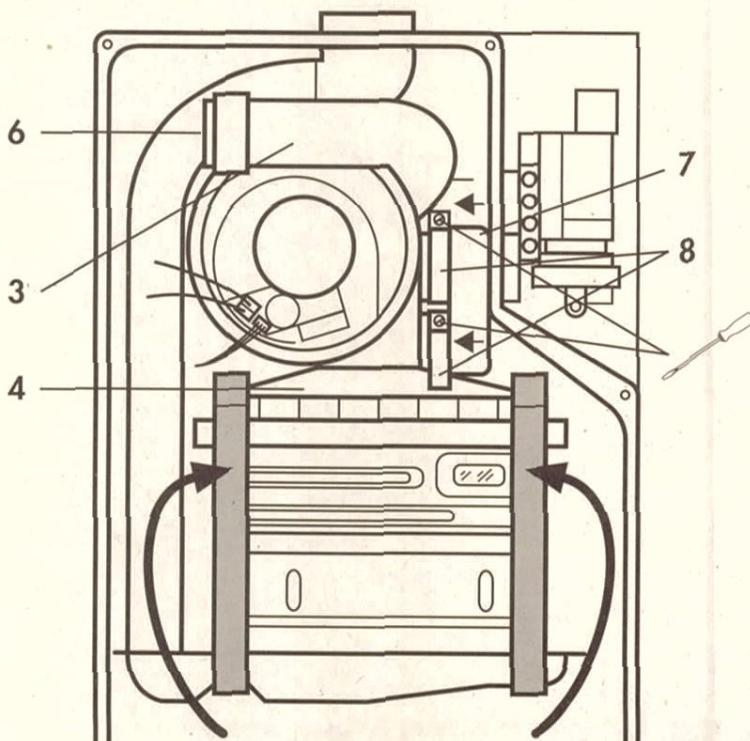
Abb. 4: Brenner mit Luftansaugrohr einbauen
