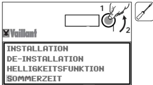
3. Drücken Sie den Bedientknopf und drehen Sie ihn anschließend nach links bis der Cursor SOMMERZEIT markiert.
