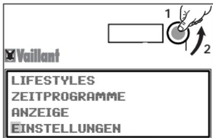
3. Drücken Sie den Bedienknopf und drehen Sie ihn dann nach links, bis der
