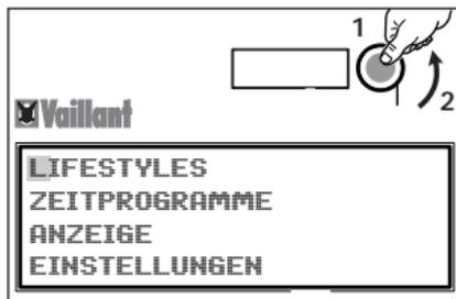
2. Drücken Sie den Bedienknopf und drehen Sie ihn anschließend nach links bis der Cursor auf LIFESTYLES steht.
