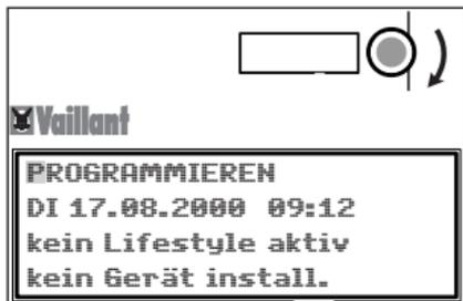
2. Drehen Sie den Bedienknopf nach rechts, bis der Cursor PROGRAMMIEREN markiert.
