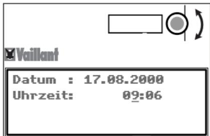
14. Durch Drehen des Bedienknopfs verändern Sie den Wert.
