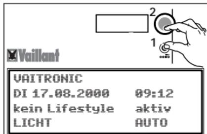
Halten Sie die Rücktaste gedrückt (1) und drücken Sie kurz den Bedienknopf (2). Die VAITRONIC Zentrale ist jetzt freigegeben. Das Schlüsselsymbol erlischt. Der Schriftzug VAITRONIC erscheint in der ersten Displayzeile.
