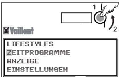
3. Drücken Sie den Bedienelementknopf und drehen Sie
