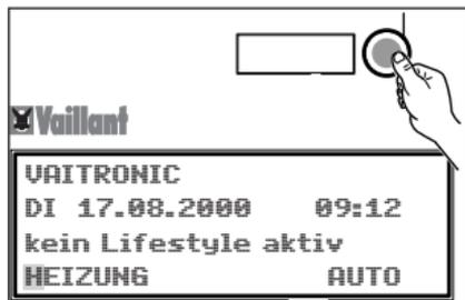
1. Wählen Sie im Standardmenü durch Drehen des Bedienknopfs nach links einen Bereich aus, z.B. HEIZUNG. Drücken Sie den Bedienknopf. Der Cursor blinkt am Anfang der letzten Zeile.
