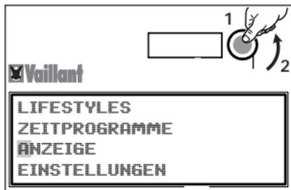
3. Knopf drücken und anschließend nach links drehen, bis der Cursor auf ANZEIGE steht.
