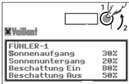
2. Sie können die Helligkeitsschwellen durch Drücken des Bedientknopfs und anschließendes Drehen ändern.
