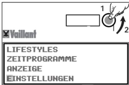
2. Drücken Sie den Bedienknopf und drehen Sie
