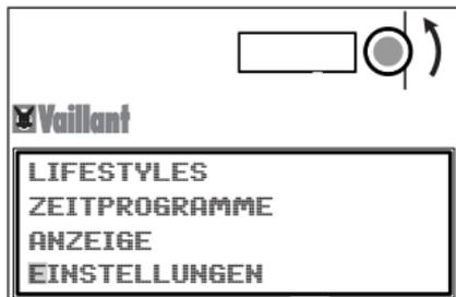
4. Drehen Sie anschließend den Bedienknopf nach links, bis der Cursor auf EINSTELLUNGEN steht.
