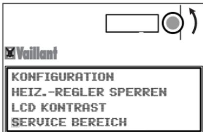
6. Drehen Sie den Bedienknopf anschließend nach links, bis der Cursor auf **SERVICE BEREICH** steht.
