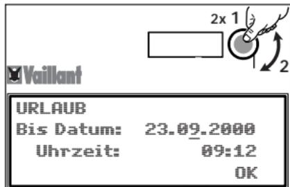
7. Drücken Sie den Bedienknopf zweimal, um den Tag zu bestätigen und den Monat zu aktivieren. Mit anschließendem Drehen ändern Sie den Monat.
