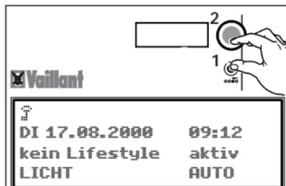
Halten Sie die Rücktaste gedrückt (1) und drücken Sie kurz den Bedienknopf (2). Die VAITRONIC Zentrale ist jetzt gesperrt. Das Schlüssel-symbol erscheint im Display.
