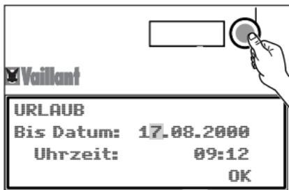
5. Durch Drücken des Bedienknopfs bestätigen Sie die Timeraktivierung. Im Display erscheint eine Datumszeile. Der blinkende Cursor steht auf dem Tag.
