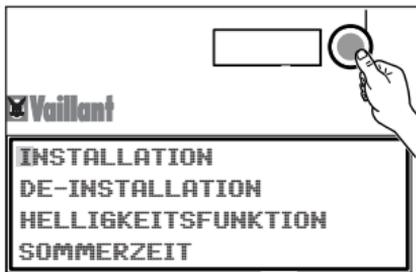
5. Drücken Sie den Bedienknopf. Der Cursor steht auf **INSTALLATION**.
