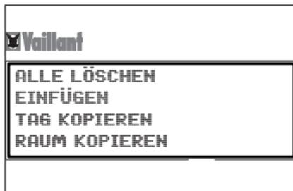
Um die Kopierfunktionen auszuwählen, müssen Sie im Menü Schaltpunkte ändern (vgl. S. 97) den Bedientknopf solange nach links drehen, bis die Zeilen TAG KOPIEREN bzw. RAUM KOPIEREN im Display erscheinen.
