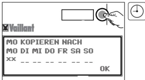
3. Knopf drücken. Der Tag, dessen Schaltpunkte Sie kopieren, ist mit einem Doppelstern „\*\*“ gekennzeichnet.
