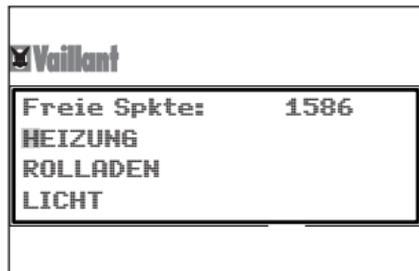
Die erste Zeile gibt die Anzahl der freien Schaltpunkte vor. Es gibt insgesamt 1600 freie Schaltpunkte. Einem Gerät können max. 255 Schaltpunkte für das Wochenprogramm zugewiesen werden.
