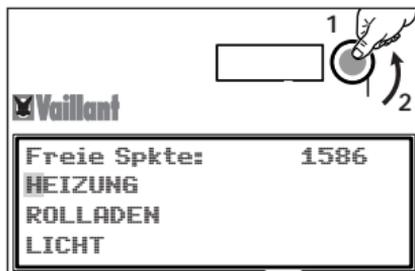
4. Drücken Sie den Bedienelementknopf. Der Cursor steht auf HEIZUNG. Durch Drehen des Bedienelementknopfs nach links können Sie auch ROLLADEN und LICHT auswählen.
