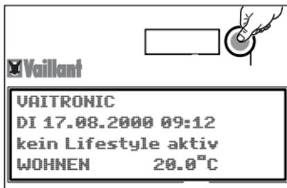
7. Durch Drücken des Bedienknopfs wird der Kaltstart bestätigt und die Datumszeile erscheint wieder im Display.
