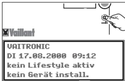
19. Drücken Sie anschließend die Rücktaste. Sie befinden sich jetzt wieder im Standarddisplay.
