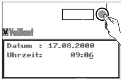
16. Drücken Sie den Bedienknopf. Die unterstrichene Minute kann geändert werden.
