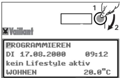
2. Drücken Sie den Bedienelementknopf und drehen Sie in anschließend nach rechts bis in der obersten Zeile PROGRAMMIEREN erscheint.
