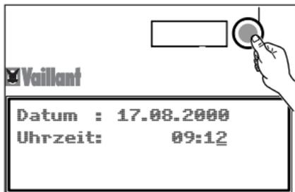
18. Drücken Sie den Bedienknopf. Die Uhrzeit ist geändert.
