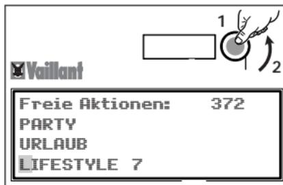
3. Drücken Sie den Bedienknopf und drehen Sie ihn anschließend nach
