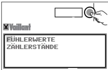
4. Drücken Sie den Bedienknopf. FÜHLERWERTE ist markiert.
