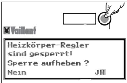
4. Drücken Sie der Bedienknopf. Der Cursor markiert JA. Radiator-Thermostat-Sperre aufheben: Knopf drücken.
