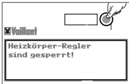
6. Wenn Sie den Radiator-Thermostat sperren wollen, dann drücken Sie den Bedienknopf. Das Display zeigt die
