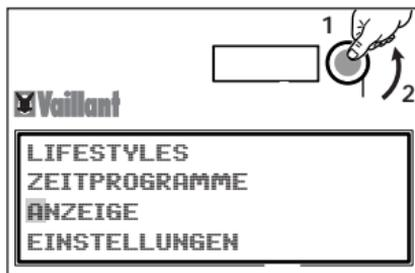
3. Drücken Sie den Bedientknopf und drehen Sie ihn anschließend nach links bis der Cursor auf ANZEIGE steht.
