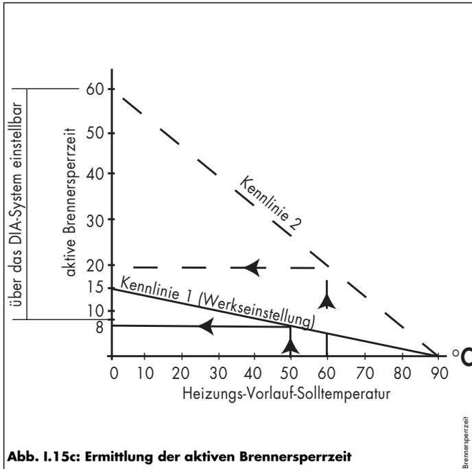
Abb. I.15c: Ermittlung der aktiven Brennersperrzeit
