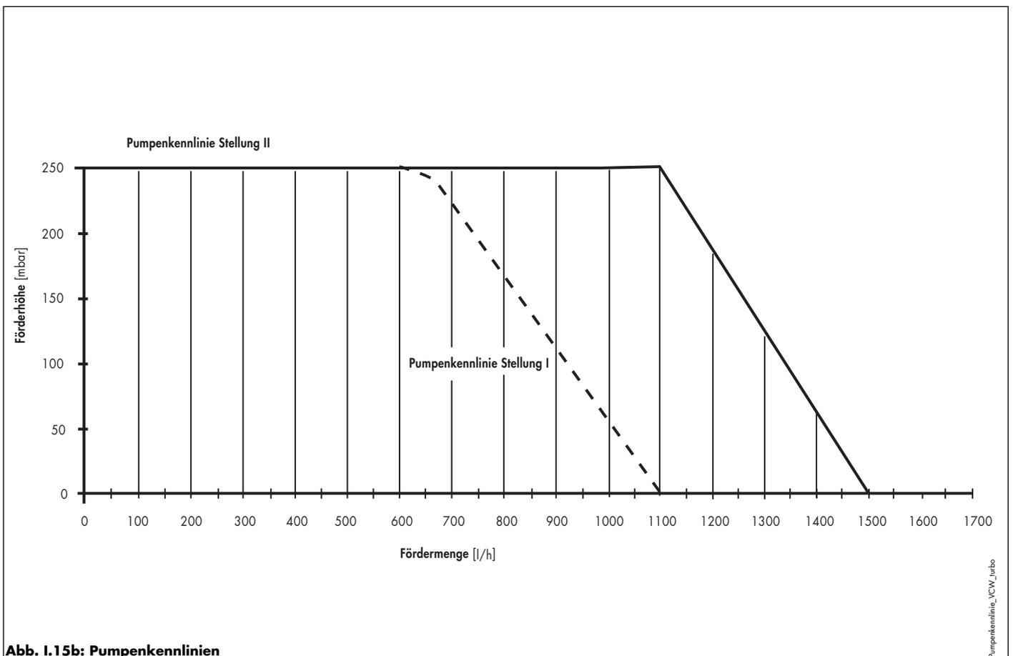
Abb. I.15b: Pumpenkennlinien
