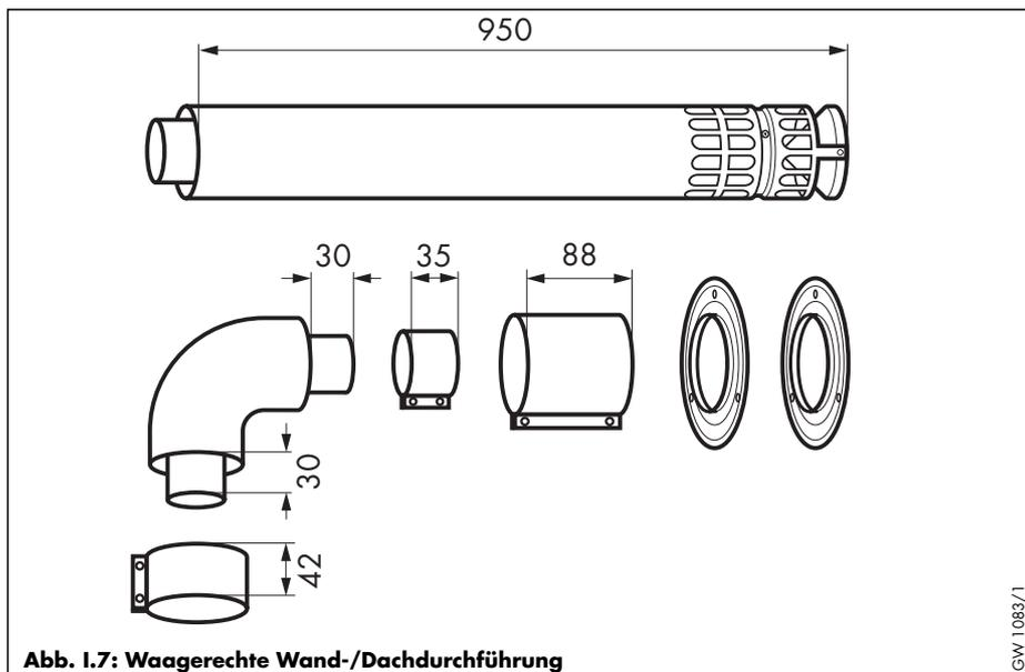
Abb. I.7: Waagerechte Wand-/Dachdurchführung
