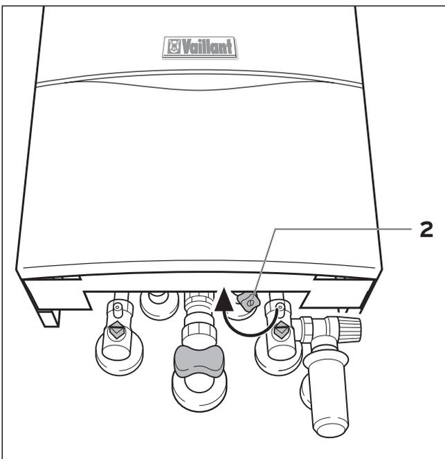
Abb. 3.2 Kaltwasser-Absperrventil schließen
