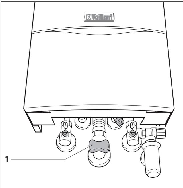
Abb. 3.1 Gasabsperrhahn schließen
