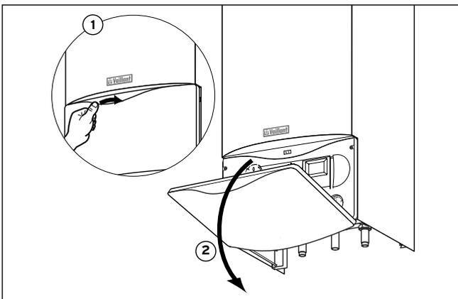
Abb. 4.3 Frontklappe öffnen
