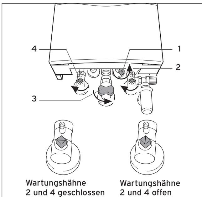
Abb. 4.1 Absperreinrichtungen öffnen
