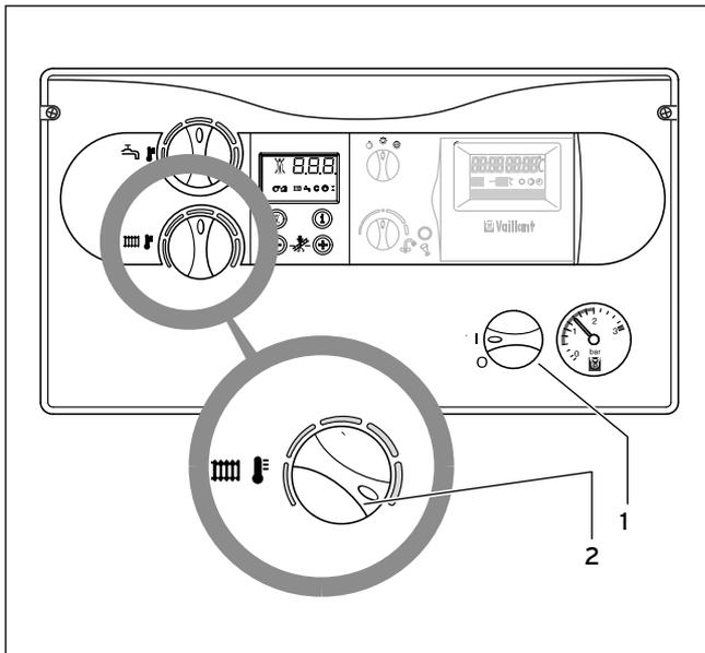
Abb. 4.11 Vorlauftemperatur-Einstellung bei Einsatz eines Regelgerätes
