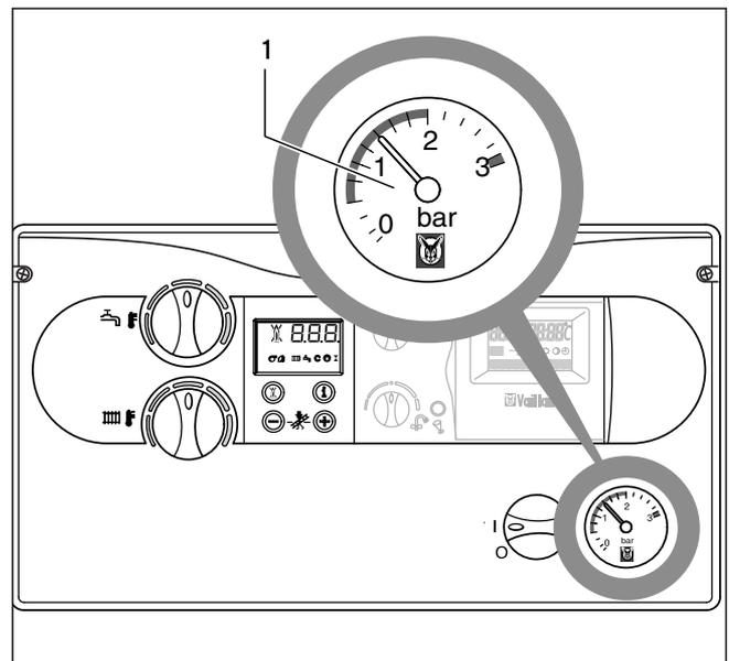
Abb. 4.2 Fülldruck der Anlage kontrollieren
