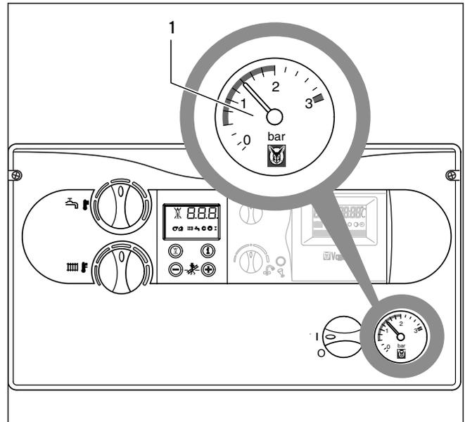
Abb. 6.1 Anlagendruck kontrollieren
