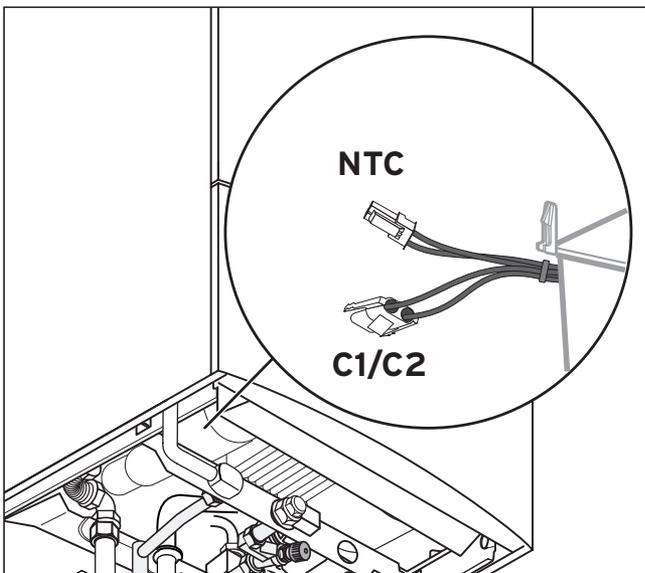
Abb. 4.8 Speicheranschluss (elektrisch)
