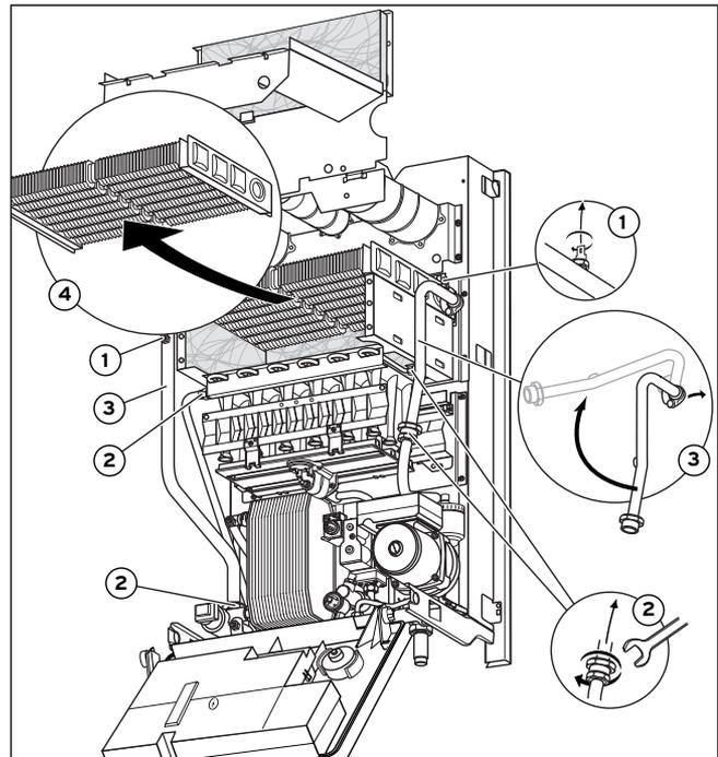
Abb. 7.2 Reinigung des Primär-Wärmetauschers mit Ausbau (stärkere Verschmutzung)
