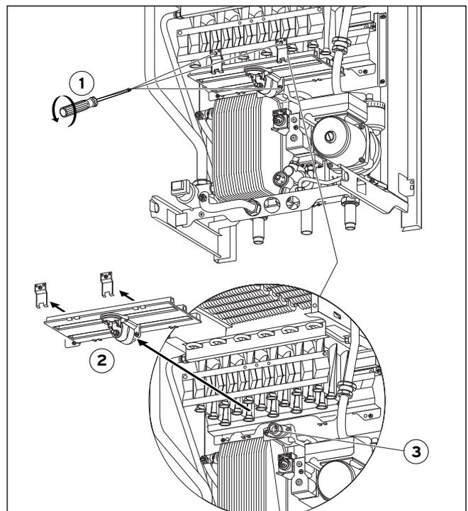
Abb. 6.2 Brennerdüsen wechseln
