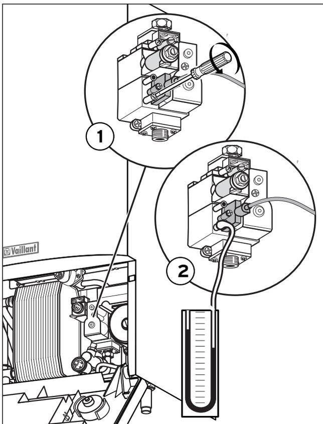
Abb. 5.2 Anschlussdruck prüfen
