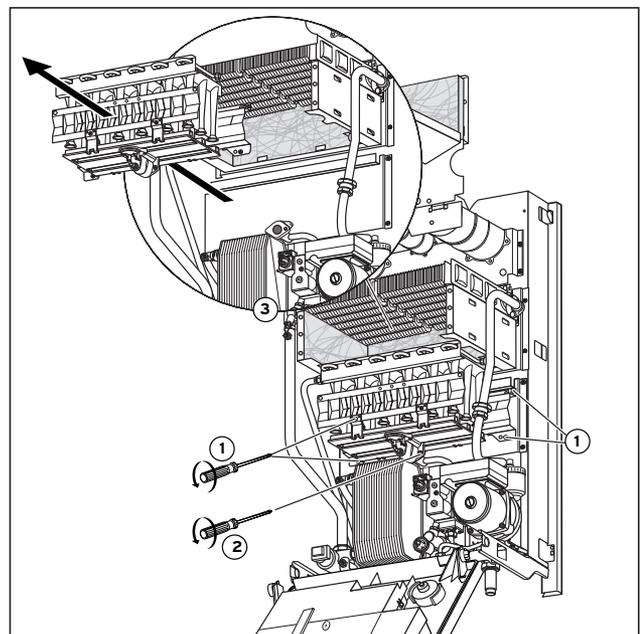
Abb. 7.3 Reinigung des Brenners mit Ausbau (stärkere Verschmutzung)
