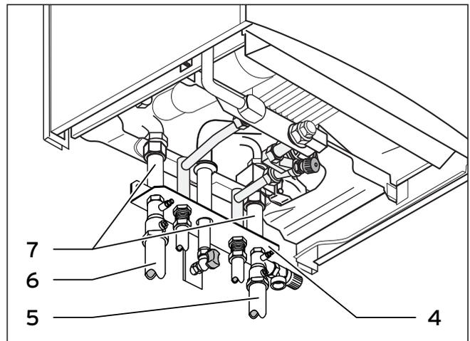
Abb. 4.3 Heizungs- vorlauf und Heizungs- rücklauf montieren
