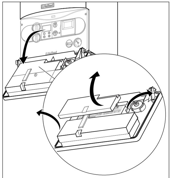
Abb. 4.5 Elektro-Anschluss vorbereiten
