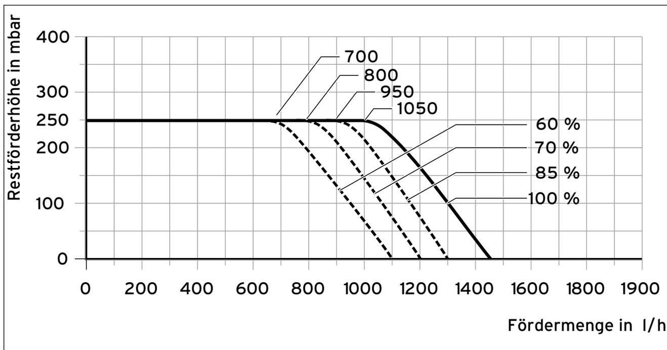
Abb. 6.1 Pumpenkennlinie
