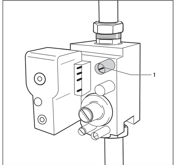
Abb. 5.1 Anschlussdruck Messstutzen
