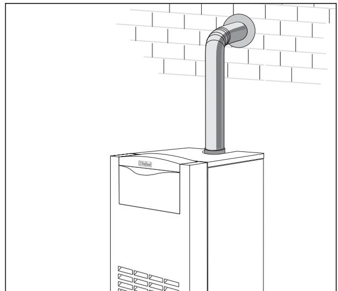
Abb. 4.3 Montage des Abgasstutzens
