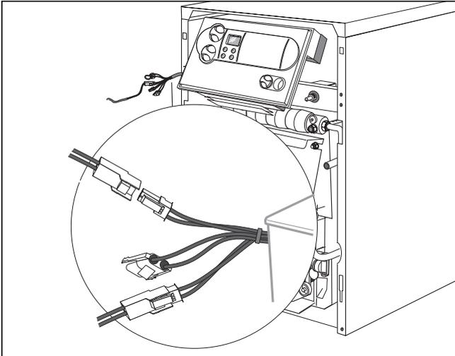
Abb. 4.6 Fühler anschließen
