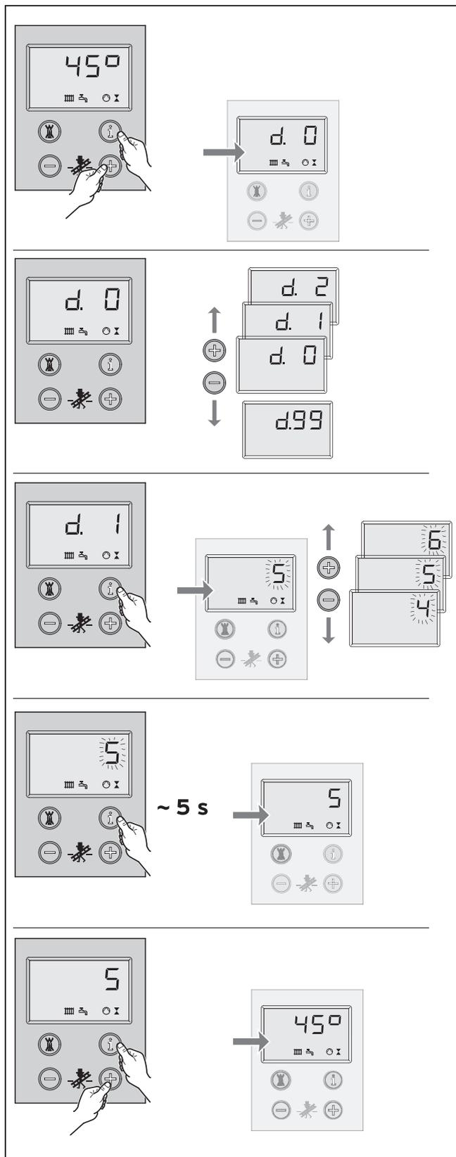
Abb. 6.1 Bedienung des DIA-Systems
