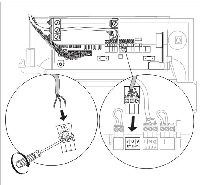
Abb. 4.7 Regelgerät an 7-8-9 anschließen
