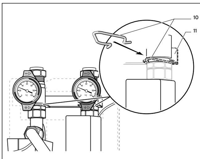
Abb. 2.2 Die Halteklammern stecken fest in einer Nut.
