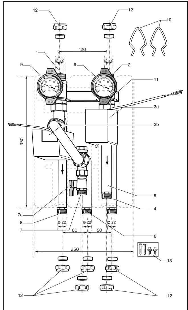
Abb. 1.2 Übersicht: Aufbau des Hydraulikblocks
