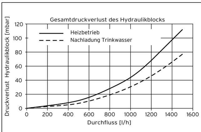
Abb. 1.1 Druckverlust Hydraulikblock
