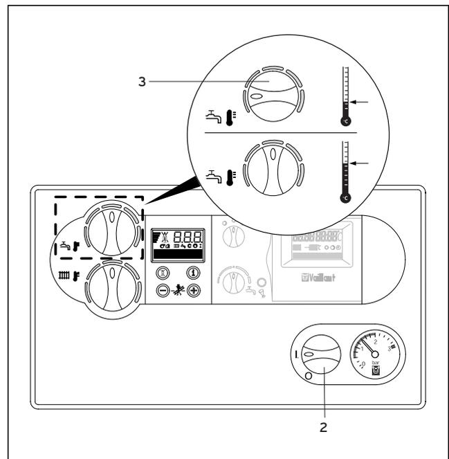
Abb. 3.5 Warmwasserbereitung
