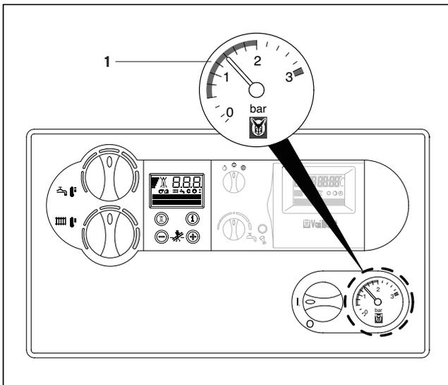
Abb. 3.4 Wasserdruck kontrollieren
