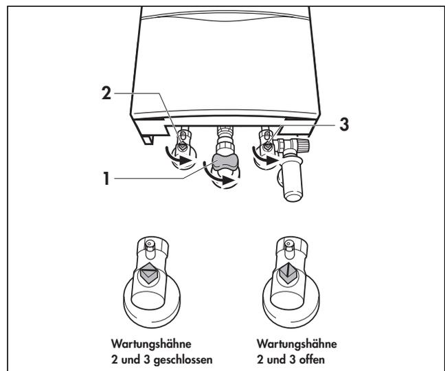
Abb. 3.3 Absperreinrichtungen öffnen
