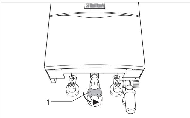
**Abb. 2.1 Gasabsperrhahn schließen**
