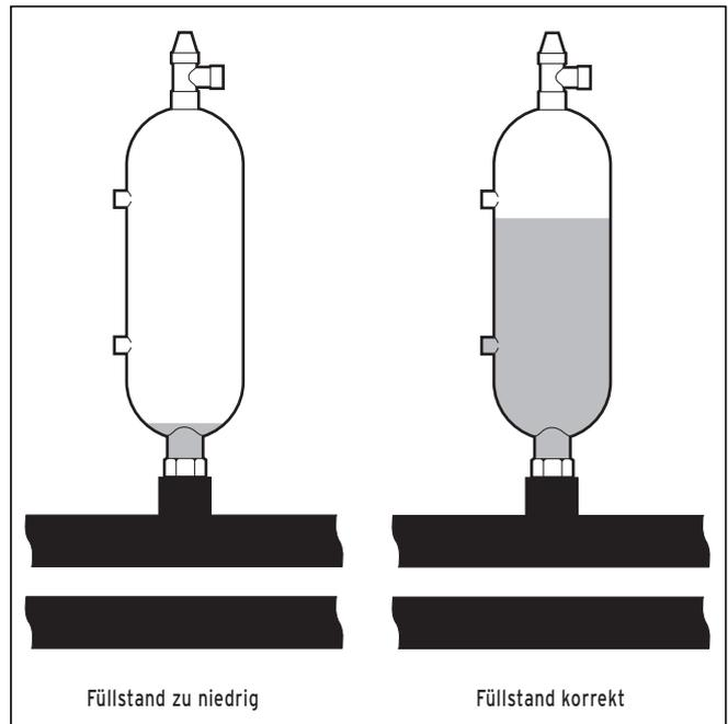
Abb. 4.12 Füllstand des Soleausgleichsbehälter
