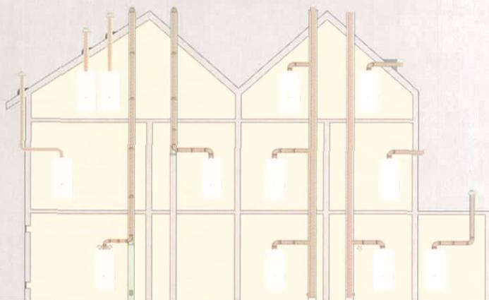
Die unterschiedlichen Anschlußmöglichkeiten für die Luft-/Abgasführung in der Übersicht.
