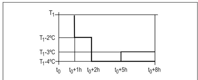
Abb. 7.22 Arbeitsweise SLEEP- Funktion im Modus HEAT.
