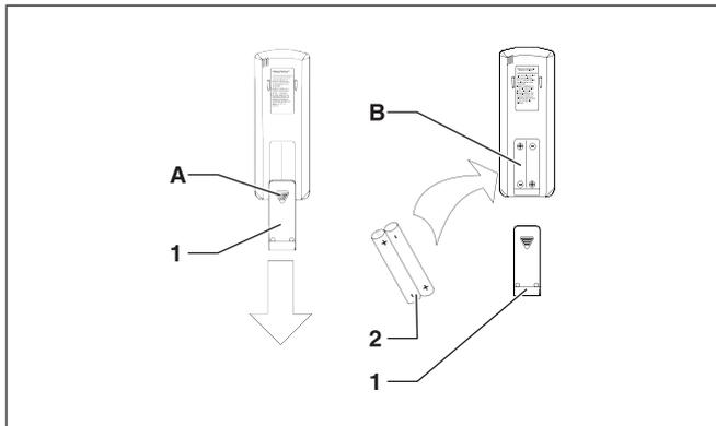
Abb. 6.1 Einsetzen der Batterien in die Fernbedienung.
