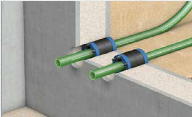
Systematische Darstellung: Einbau Curaflex Nova® Uno/breit
