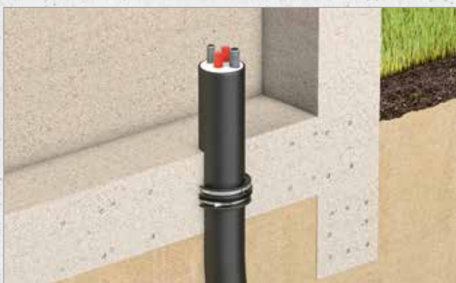
Systematische Darstellung: Einbau HKD Mauerkragen
