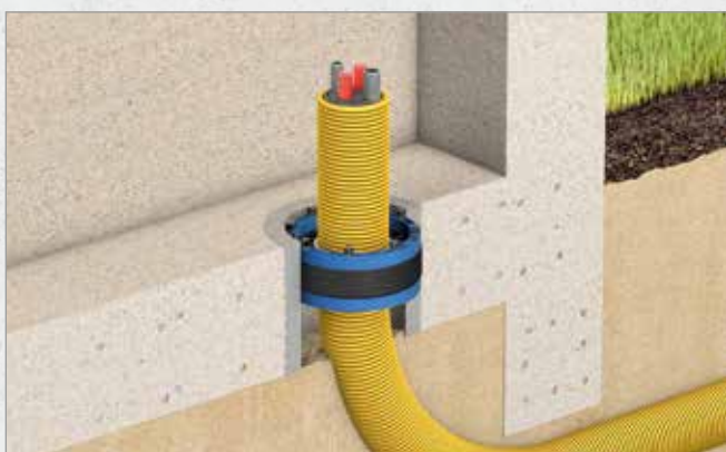
Systematische Darstellung: Einbau Dichtungseinsatz Curaflex Nova® Senso in Kombination mit Futterrohr Curaflex® 3000
