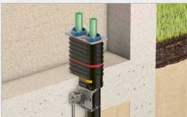
Systematische Darstellung: Einbau Quadro-Sicura® Basic R2
